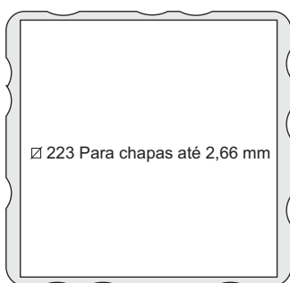
FURAÇÃO PARA MONTAGEM
